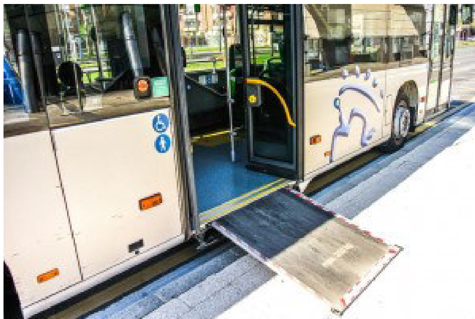
Рисунок 4.19.1 – Автоматический выдвигаемой пандус для инвалидов
